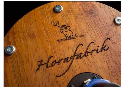
Weider was gelernt: Die vermeintliche Gravur auf der Horn-Rückseite ist gelasert
