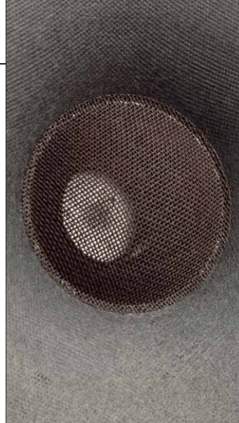
Unter der luftdurchlässigen Dustcap kann man einen Blick auf den Polkern und die Schwingspule erhaschen
