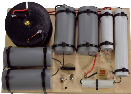
Die Weiche ist mit ausgesuchten Bauteilen speziell an die Treiber in der Box individuell angepasst
